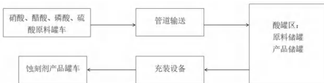
图2-8 酸罐区装卸流程简图
